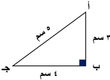
$$\text{جا ج} = \frac{\text{المقابل}}{\text{الوتر}} = \frac{3}{5} \quad , \quad \text{جتا ج} = \frac{\text{المجاور}}{\text{الوتر}} = \frac{4}{5}$$
